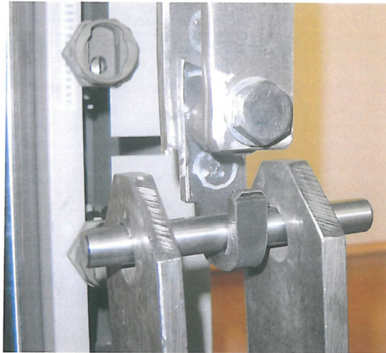
foto2: Prueba de tracción de un gancho hasta 67,5 kg con detección de la deformación
