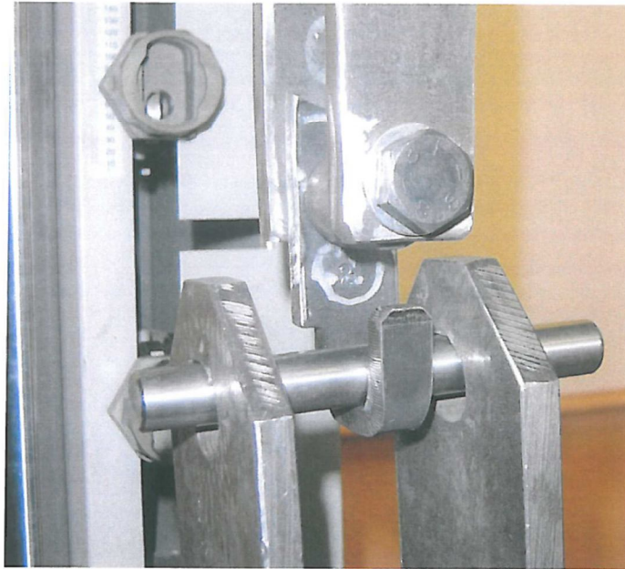
Foto 2: Prova di trazione dei un gancio fino a 67,5 kg con registrazione della deformazione
